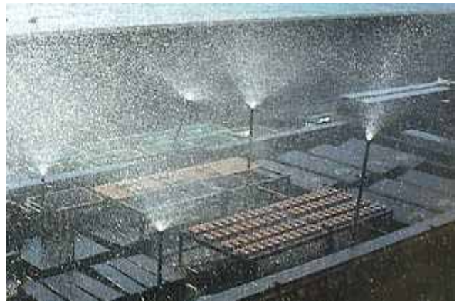
照片 海水淋湿的试验状况
