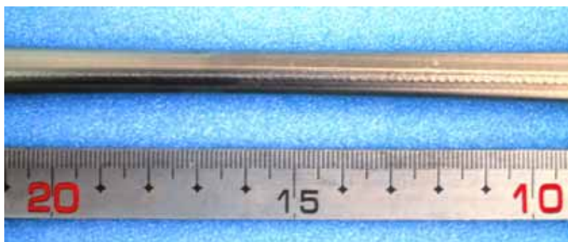
图7 NAS H840 的等离子焊接管 30% 拉伸试验后的外观
